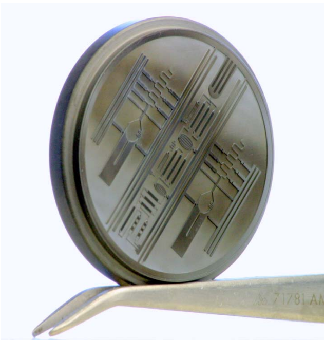
Abbildung: SiC-Werkzeug zur Mikrofluidik-Strukturierung von HbA1c-Sensoren (Fh-IWU / SensLab)
