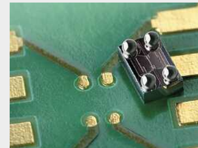
Magneto-resistiver GMR-Sensor von Sensitec. (Quelle: Sensitec GmbH)
