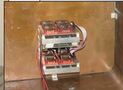
Sensorplatinen auf Halterung in Klimakammer
