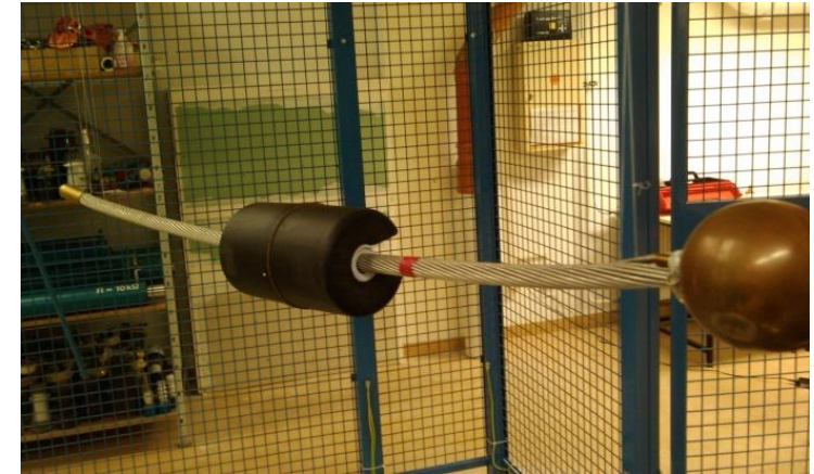
Harvester-Elektrode (Cu beschichtetes Gehäuse) im Hochspannungslabor
